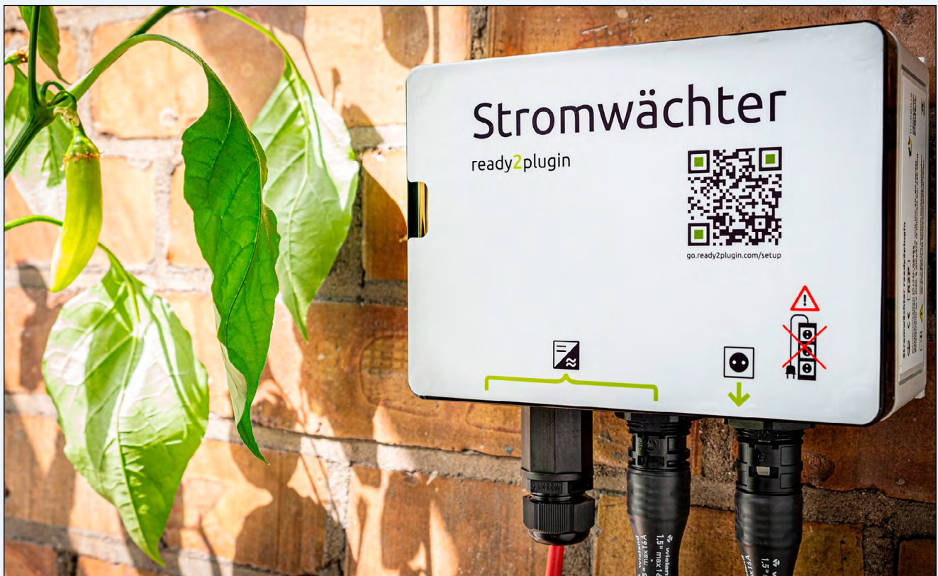
Bild 1: Der Stromwächter begrenzt die Strombelastung der Einspeisephase und erfüllt somit die Vorgaben an die Strombelastbarkeit von Kabeln und Leitungen
