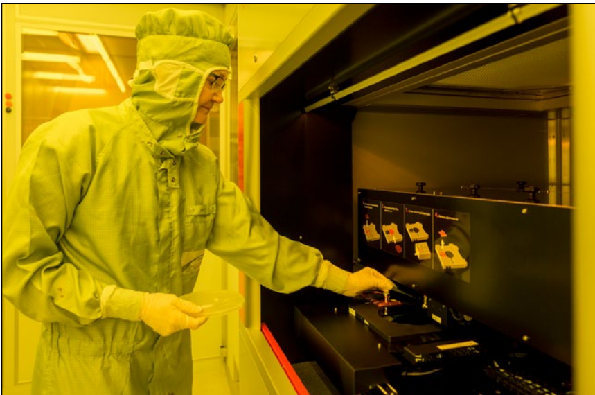
Bild 1: Laserbelichter zur maskenlosen, photolithographischen Strukturierung von Wafern für höchsteffiziente Solarzellen
