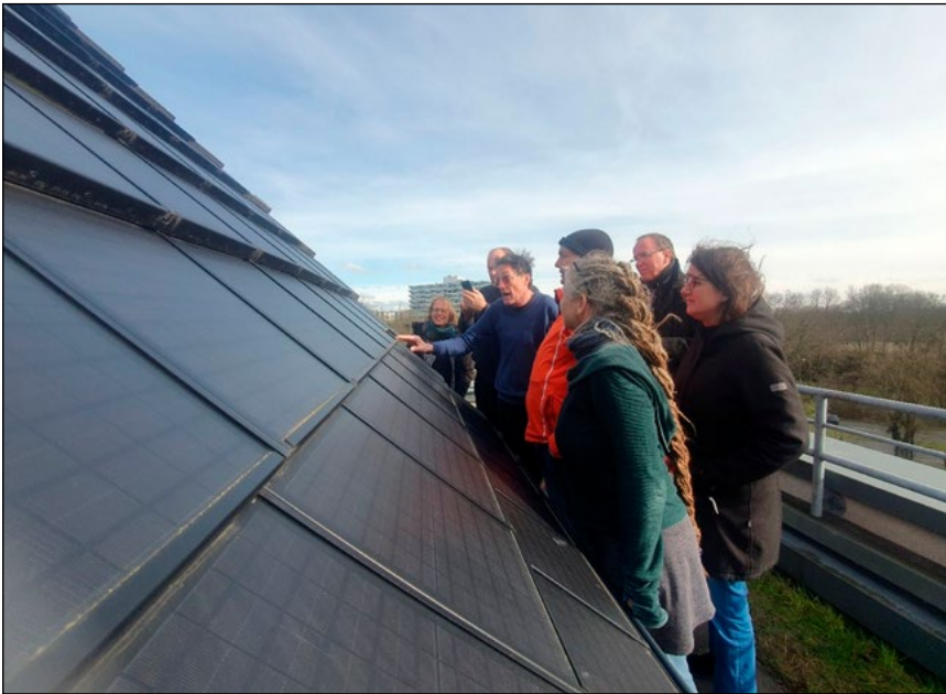
Bild 1: Dachlabor zum Vergleich verschiedener PV-Module; hier: dachintegrierte PVT-Module
