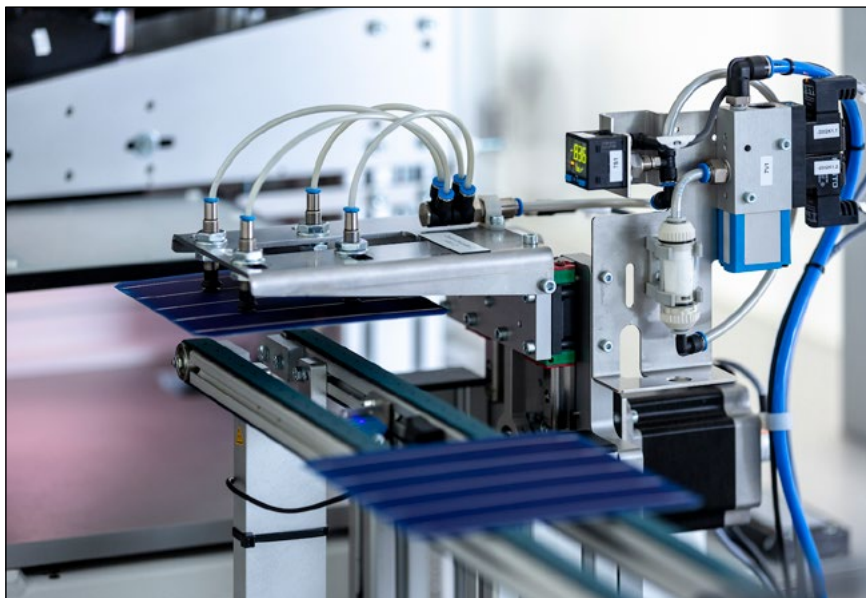
Bild 2: Greifer und Bandstrecke im automatisierten Solarzellen-Tester
