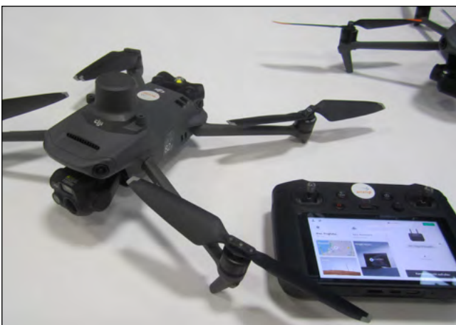
Bild 6: Luftunterstützung durch DJI Mavic 3T: Drohne mit Foto- und Infrarot-Kamera erleichtert die Fehlersuche
