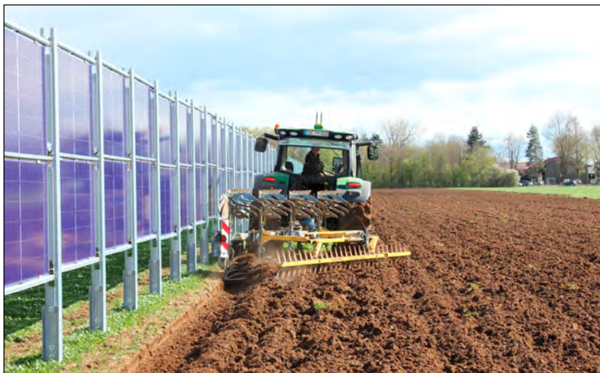
Bild 2: Das exakte Fahren ist wichtig, damit die Gestelle und Module nicht beschädigt werden
