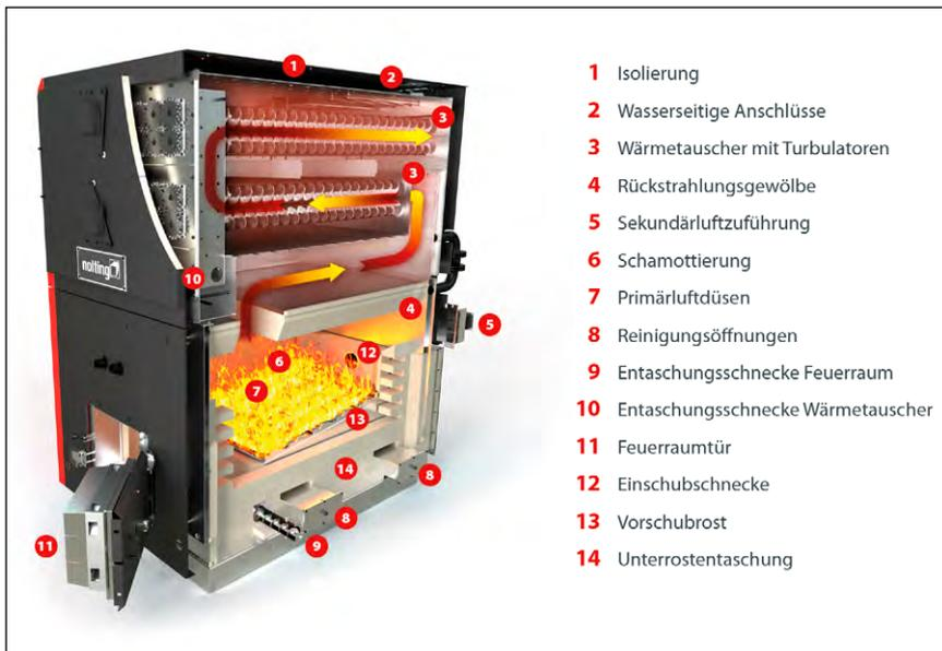
Bild 2: „Innenleben“ des Biomassekessels vom Typ LCS-RV mit automatischer Vorschubrostfeuerung, den es in 13 unterschiedlichen Größen von 70 bis 2.500 kW gibt
