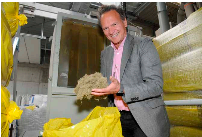
Bild 5: Die Wiesengras-Fasern werden in möglichst hoher Konzentration dem Kunststoff-Granulat beigemischt, um den ökologischen Fußabdruck des Endproduktes zu minimieren. Auf dem Bild: Geschäftsführer Jens Meyer zu Drewer
