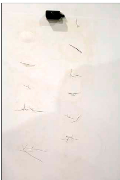
Bild 5: Rückseite eines Moduls, bei dem ebenfalls die mittlere Bypassdiode nicht korrekt verlötet war. Die Modulglasscheibe war noch intakt. Lediglich an der Rückseitenfolie gab es bereits deutliche Zeichen von Überhitzung.
