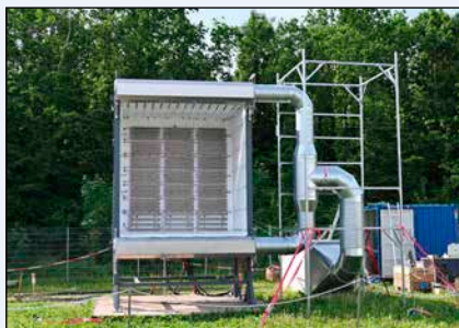
Bild 2: Experimenteller Nachbau eines solarthermischen Cavity-Receiver in Freiburg.
