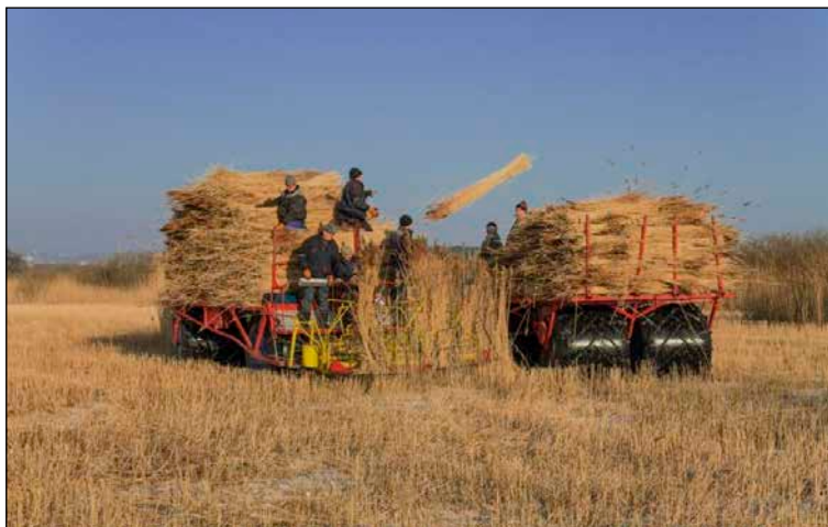
Bild 2: Dachschilfernte mit Seiga auf Ballonreifen (links) und einer Ernteraupe (rechts)
