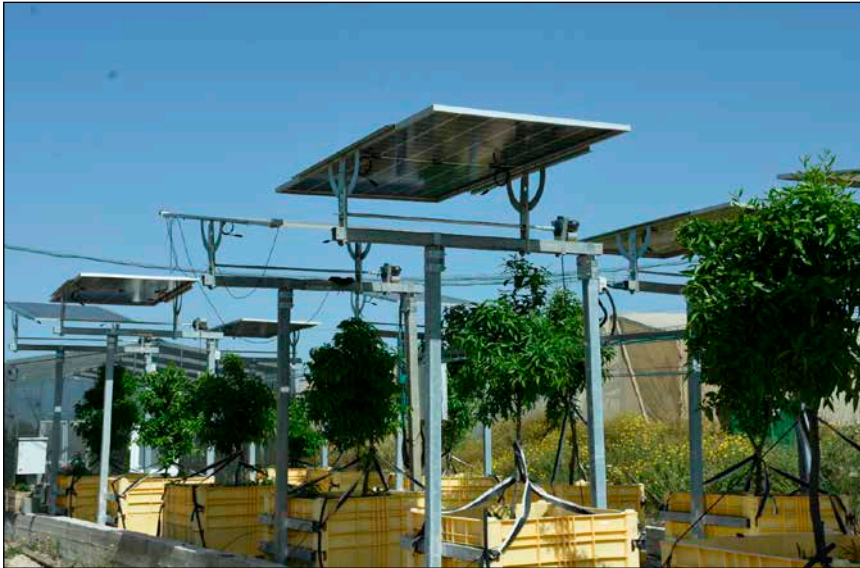
Bild 1: Versuche mit kleinräumiger Agri-PV am Gilat Research Center for Arid & Semi-Arid Agricultural Research in Rishon LeZion, Israel
