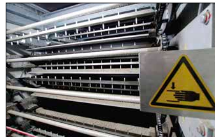
Bild 3: Je weiter nach unten das zu trocknende Gut auf den Stahllagen rieselt, umso trockener ist es.
