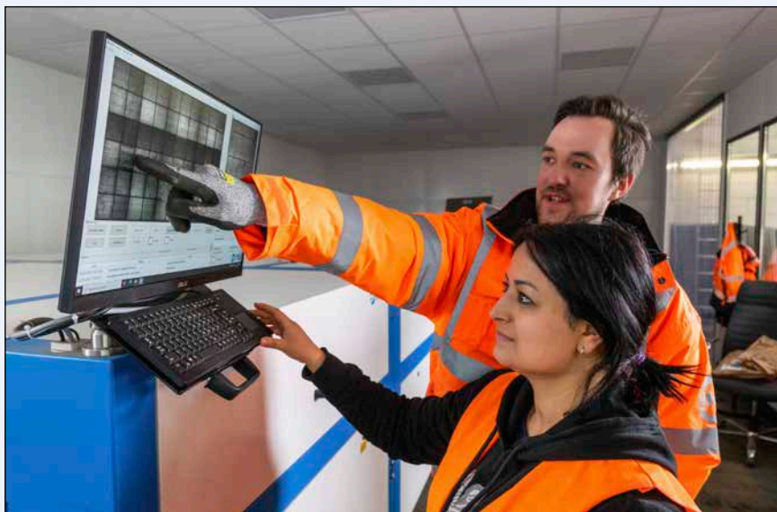
Bild 1: Prüfung des EL-Bildes durch zwei Mitarbeitende der 2nd Life Solar
