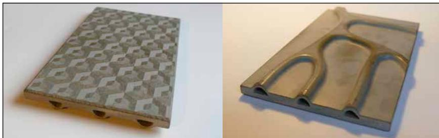
Bild 3: Mikro-Oberflächenstrukturierung (links) und FracTherm®-Struktur (rechts) als Gestaltungselement.
