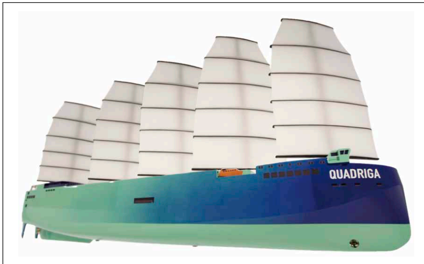
Bild 1: Entwurf eines modernen Rahseglers, der größtenmäßig den heutigen Fossil-Frachtern in Nichts nachsteht. Eine Version, die 240 Meter lange Quadriga Aqua , soll sogar als schwimmende Fisch-Farm dienen.
