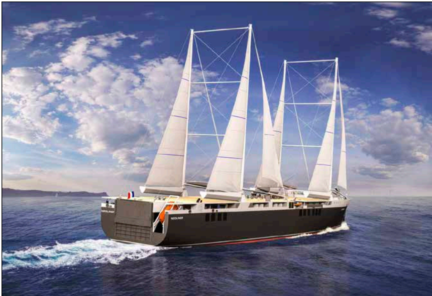
Bild 4: Der französische Neoliner ist auch insofern besonders, als dass die Masten nicht schiffsmittig stehen, sondern in zwei „Kolonnen“ an Back- und Steuerbord
