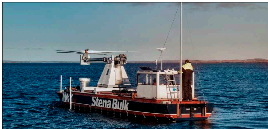
Bild 2: Schwedisches Versuchsmodell mit umklappbarer Windkraftanlage. Wie bei künftigen Windturbinen-Schiffen soll der geklappte Rotor nicht auf dem Deck aufliegen – da würde er die Ladearbeiten behindern.
