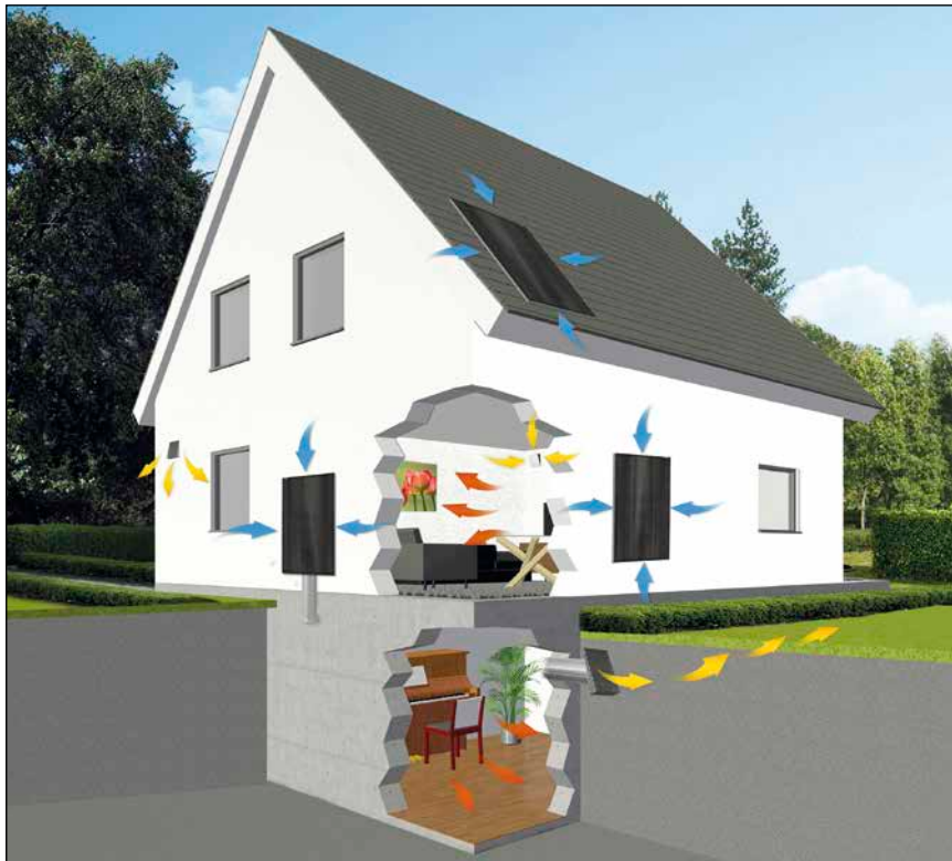
Bild 1: Ob auf dem Dach oder an der Hauswand montiert – Luftkollektoren bringen frische Wärme ins Haus.
