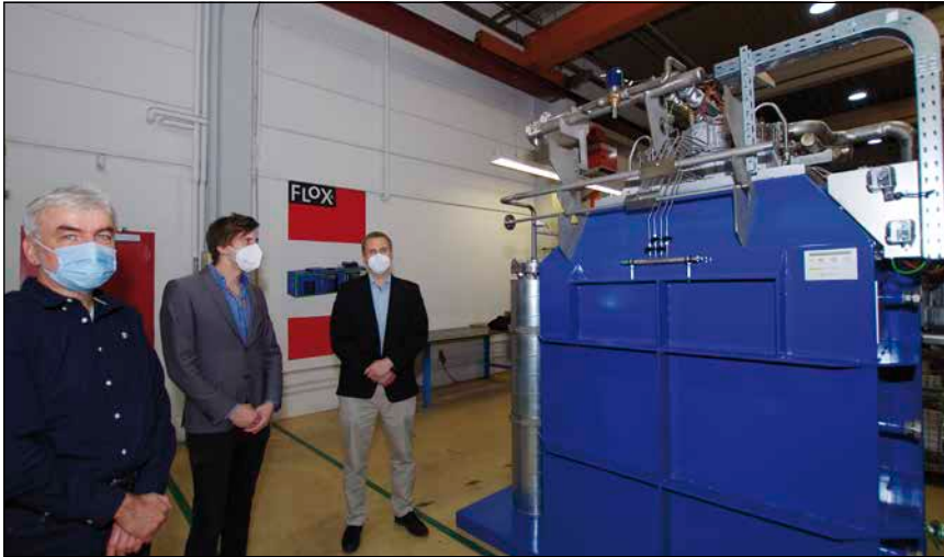
Bild 1: Der erste fertige Biogas-Reformer im WS-Werk, bevor er in den Container eingebaut wurde. Auf dem Bild von links: Die Geschäftsführer Dr. Roland Berger (eflox GmbH), Dr. Andy Gradel (BtX GmbH) und Dr. Martin Schönfelder (WS-Wärmeprozessstechnik GmbH)
