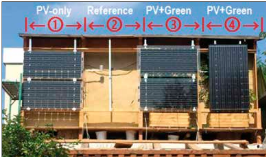
Bild 1: Der Teststand der TU Wien für die modularen Kombinationen aus Fassaden-, Begrünungs- und Solarenergieelemente. Die einzelnen Einheiten können ausgetauscht werden; hier wäre auch eine Kombination mit Röhrenkollektoren möglich.
