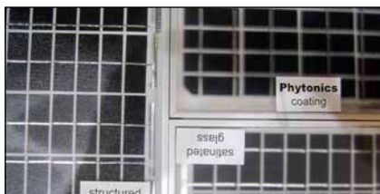
Bild 5: Die Beschichtung von Photonics reduziert die Blendwirkung eines Solarmoduls deutlich
