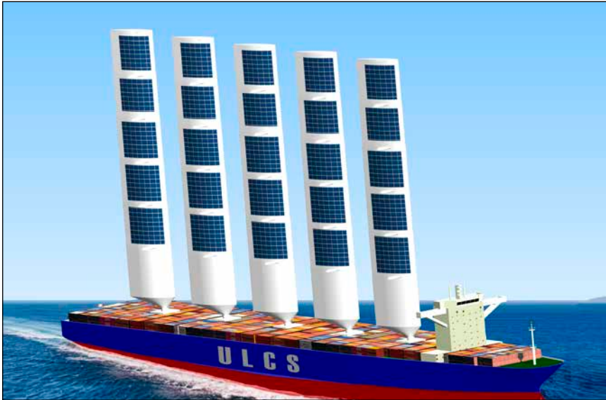
Bild 1: Entwurf für ein umgebautes Ultra Large Container Ship mit Windantrieb und PV auf den einfahrbaren Segelprofil-Segmenten
