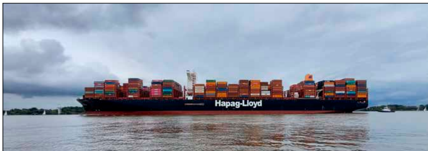
Bild 2: Die 400 m lange und 58,6 m breite Al Nefud mit ihren 18.800 TEU zeigt deutlich die Trennung zwischen Brücke vorn, und der Maschinenanlage (oranger Schornstein) hinten.
