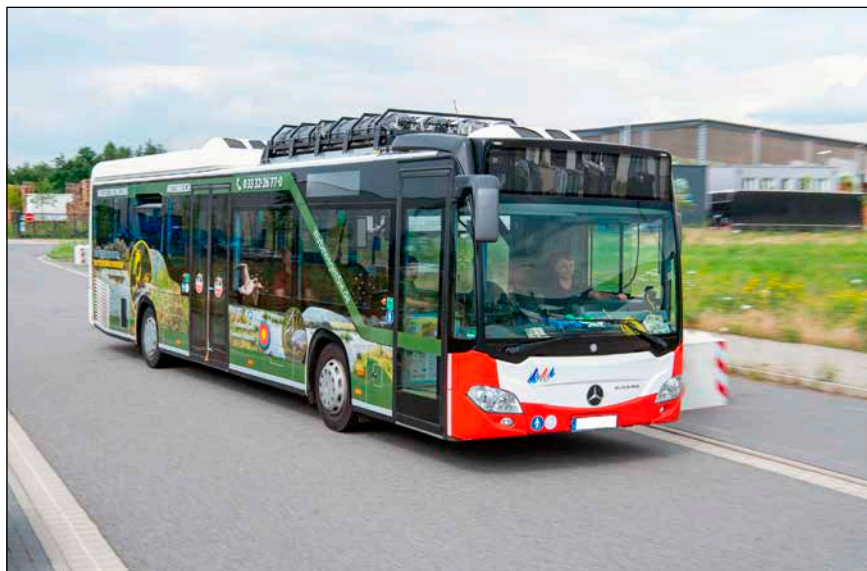
Bild 1: Ein von der Fa. Clean Logistics auf Wasserstoff und Brennstoffzellen umgerüsteter Mercedes-Bus
