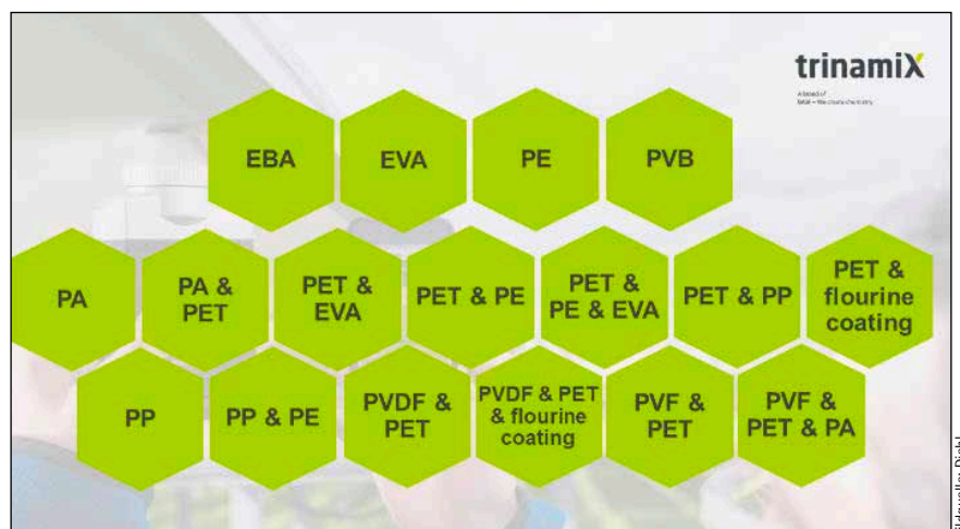
Bild 7: Die vom Trinamix Spektroskopiegerät erkannten Materialien, die typischerweise in Rückseitenfolien eingesetzt werden.
