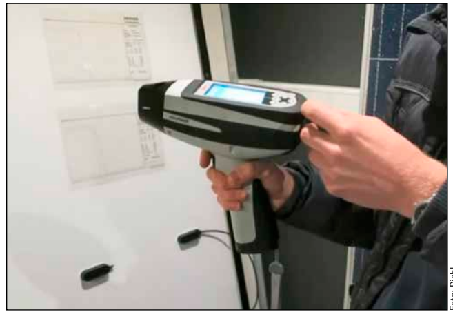
Bild 6: Untersuchung der Rückseitenfolien von Solarmodulen mit mobilen Geräten zur FTIR (Fourier Transform Infrared Spectroscopy)
