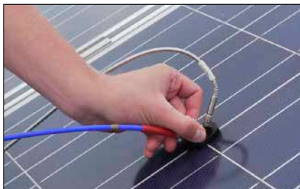
Bild 1: Die Modulflüsterer bei der Arbeit. Hier mit dem „Modul Stethoskop“, mit dem die NIRA Messungen durchgeführt werden.
