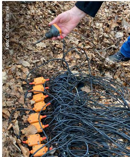
**Seismik-Messung** Geophone sind elektro-mechanische Wandler, die Bodenschwingungen in analoge Spannungssignale umwandeln
