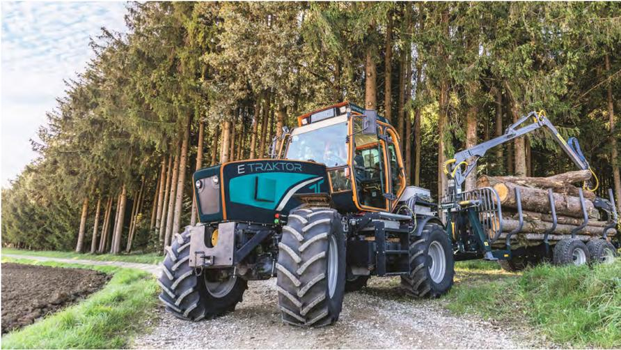
Elektro-Schlepper Erprobungsfahrzeug mit Rückewagen
