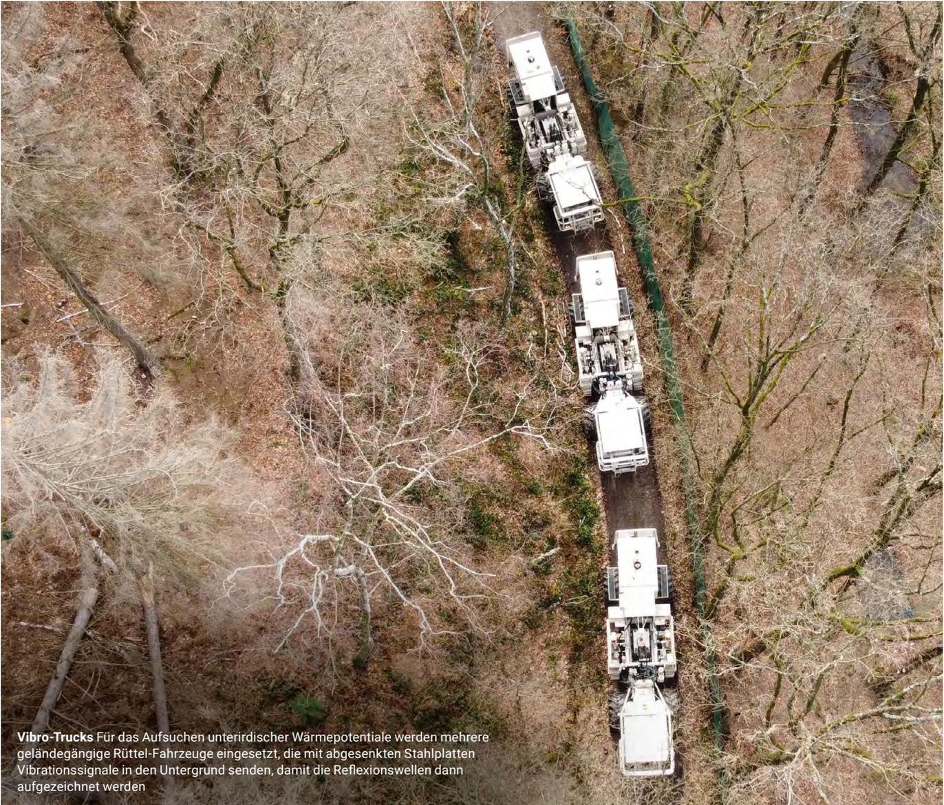
**Vibro-Trucks** Für das Aufsuchen unterirdischer Wärmepotentiale werden mehrere geländegängige Rüttel-Fahrzeuge eingesetzt, die mit abgesenkten Stahlplatten Vibrationssignale in den Untergrund senden, damit die Reflexionswellen dann aufgezeichnet werden
