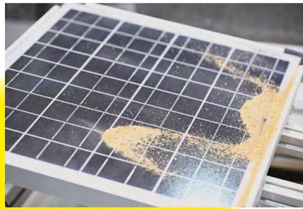
**Sandkörner** Durch Vibrationen rieselt Sand von der Solarmodulfläche herunter
