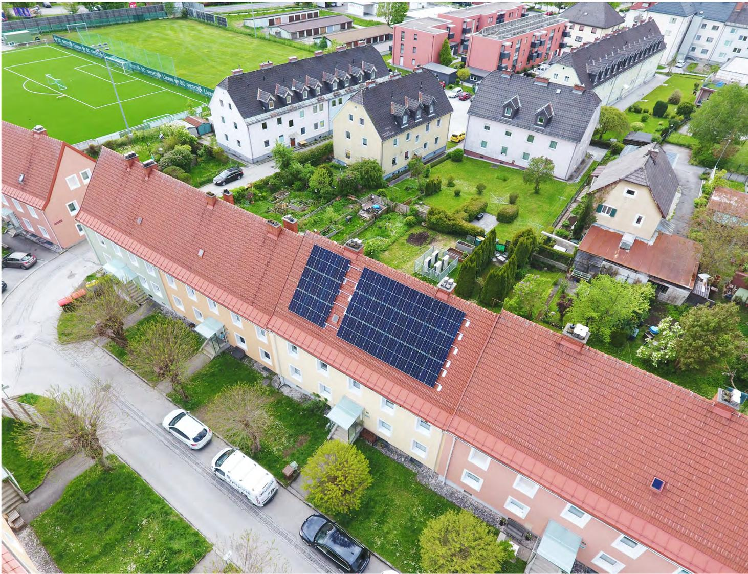
**Klimaschonend** Das HAPPENING-System kommt in einem zusammenhängenden Riegel aus fünf Gebäuden in Liezen zum Einsatz. Heizzentrale und Photovoltaik-Anlage sind im beziehungsweise auf dem mittleren Gebäude installiert. Klein in weiß hinter dem Gebäude zu erkennen sind die Außeneinheiten der Luftwärmepumpen
