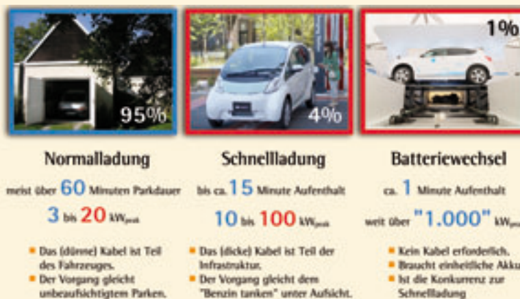
Grafik 3: Nur die Normalladung kann als „Netzintegration“ bezeichnet werden, denn nur in diesem Fall ist eine zeitliche Verlagerung der Energieübertragung möglich. Die eher selten erforderlichen Systeme für die Schnellladung und den Batteriewechsel fallen in die Kategorie des „Strom tankens“.
