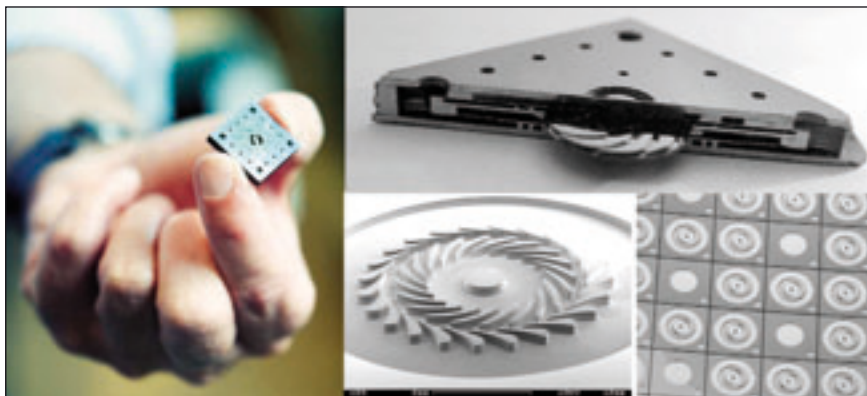
Bild 2: Power-MEMS von der MIT Forschungsgruppe um Professor Alan Epstein (links). Schnittansicht des H 2 Gasturbinen Chips (rechts oben). Siliziumwafer mit radialen Gaseinlassstufen für die Mikroturbine (rechts unten).
