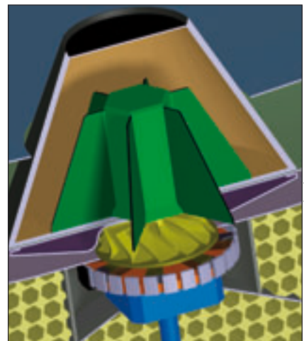
Bild 4: Detailzeichnung des Receivers mit Latentwärmespeicher, Mikroradialturbine sowie Generator und Mikrospeisepumpe
