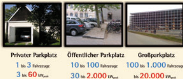
Grafik 2: Die verschiedenen Standorttypen führen zu einer unterschiedlich hohen Maximalbelastung der Stromnetze. Doch bereits der vermeintlich einfachste Fall, der private Parkplatz, zwingt bereits zu Lösungen für intelligentes Laden.
