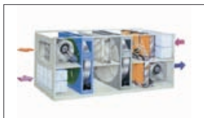
Bild 5: Einblick in eine offene, sorptionsgestützte Klimaanlage
