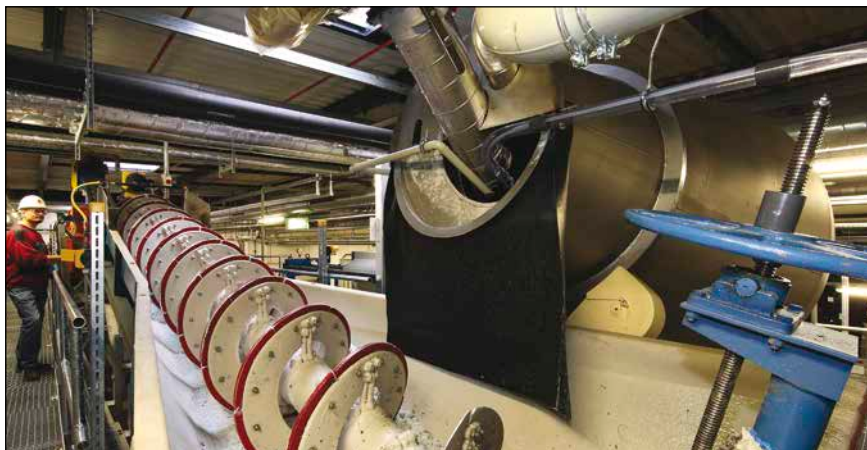
Bild 1: Schreddern von Dünnschichtmodulen zur Weiterverarbeitung
