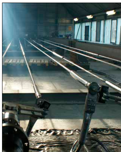
Bild 2: Versuchsstand mit HTLS-Leitenseilen
