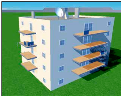
Bild 4: Das vereinfachend gewählte Referenzgebäude mit Flachdach nachgebildet in PVSOL für einen Sonnenstand um etwa 16 Uhr im Juni. Der Einbau der berechneten Bürger-PV-Anlagen wird exemplarisch an vier Situationen (von links nach rechts) gezeigt: West-Balkon und West-/90°-Ausrichtung des Moduls, West-Balkon und seitliche Süd-/90°-Ausrichtung des Moduls, Süd-Balkon und 90°-Ausrichtung des Moduls, Süd-Balkon und 70°-Ausrichtung des Moduls. Sichtbar ist auch der Einfluss der Verschattung vor allem bei überliegenden Balkonen.
