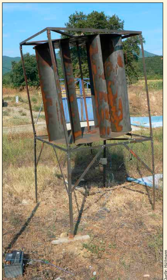
Mit ihrer vertikalen Achse fungiert die einfache Windturbine unabhängig von der Windrichtung
