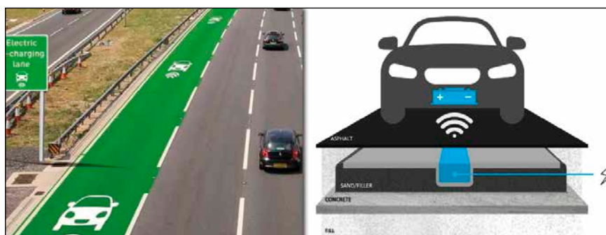
Bild 3: Symbolbild und Funktionsschema des Induktions-Betons
