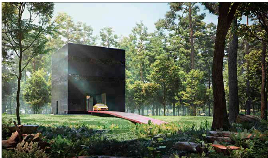
Bild 1: Aussenansicht der „Black Villa“: Die Fassade des autarken Wohnhauses ist mit einheitlichen schwarzen Photovoltaik-Paneeelen verkleidet.
