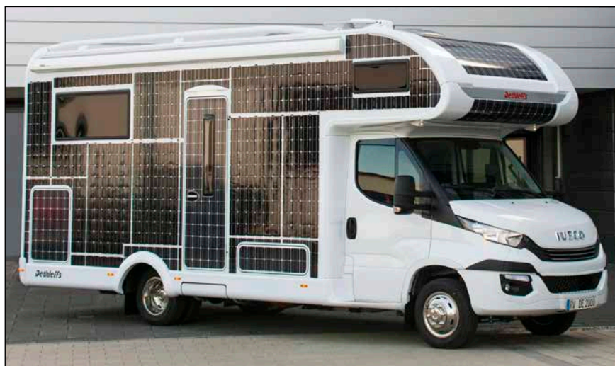
Bild 8: Dethleffs 2017 als Prototyp vorgestelltes, vollelektrisches Solarwohnmobil
