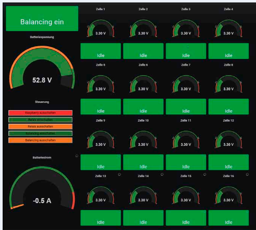
Bild 4: Dashboard eines Batterie-Management-Systems
