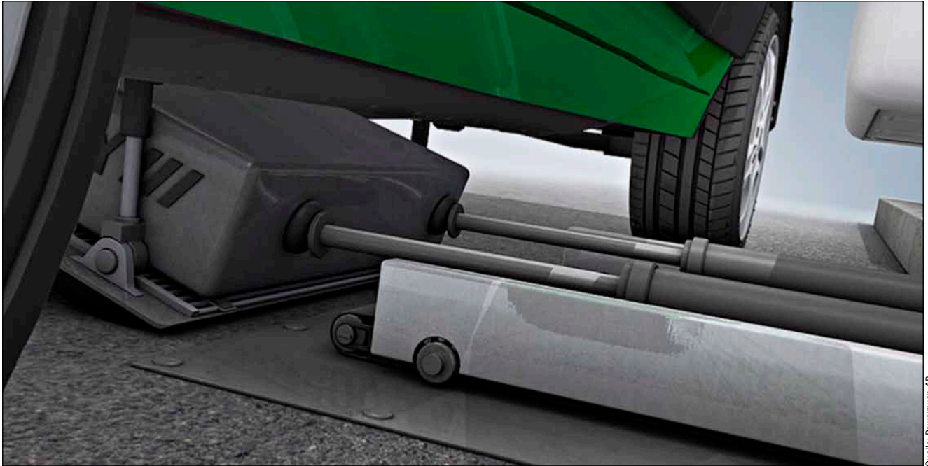
Bild 1: Akkutauch von der Seite mit dem schwedischen Powerswap-System
