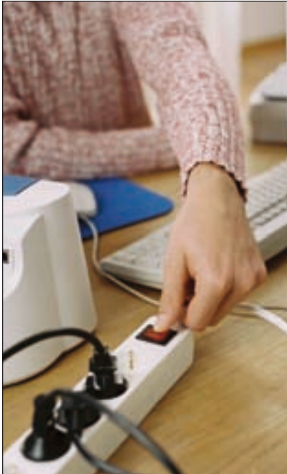
Schaltbare Steckdosenleiste verhindert unnötigen Stand-by-Verbrauch
