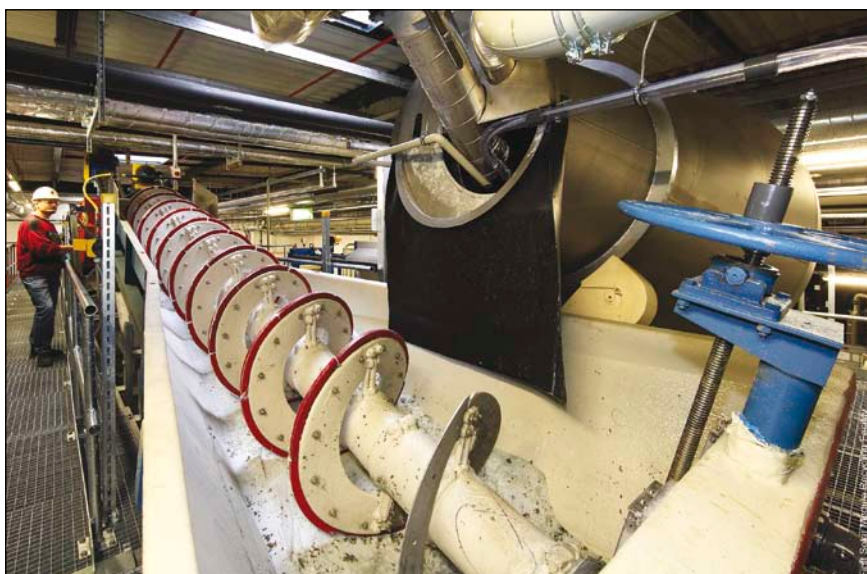
Bild 1: Schreddern von Dünnschichtmodulen zur Weiterverarbeitung
