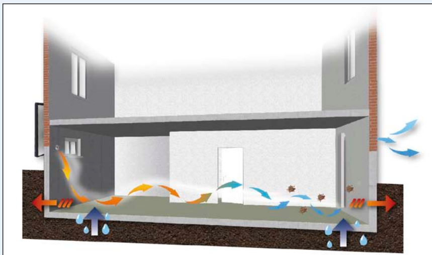
Bild 1: Der Luftkollektor arbeitet autark. Eine Absaugeinrichtung zieht die feuchte Luft aus dem Keller.
