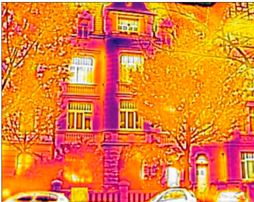
Bild 1: Vorstehende Hausecken kühlen schnell aus
