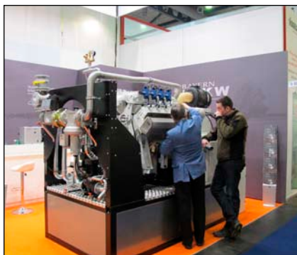
Biogas-BHKW sind inzwischen für die flexible Fahrweise optimiert
