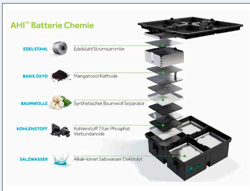
Bild 1: AHI Aufbau und Batterie-Chemie
