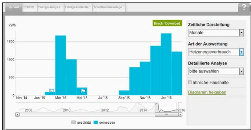
Bild 1: Verlauf des Nachheizbedarfs nach Installation einer Nahwärmeheizung (Ende Februar) und eines Sonnenkollektors (Anfang Mai)
