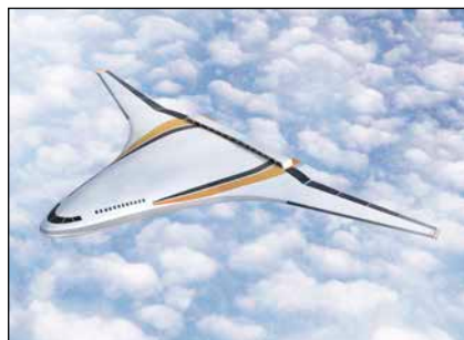
Bild 3: Die N3-X ist fast ein Nurflügler; sie hat ihre Fans hinten auf dem platten Rumpf.
