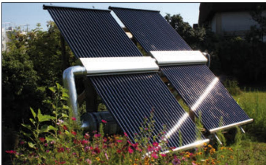
Bild 1: Kollektoranlage zum Bambustempen in Bötzingen (Typ „Sunstorm“, Kollektorfabrik)
