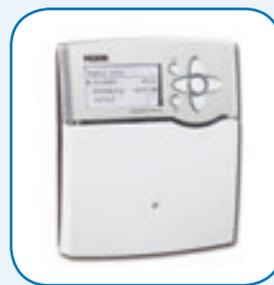
Der neueste Zuwachs unserer DeltaSol®-Familie heißt **BX Plus**. Der Systemregler ist mit fünf Relaisausgängen und neun Sensoreingängen ausgestattet, verfügt über Anschlüsse für digitale Grundfos Direct Sensors™ sowie PWM-Ausgänge zur Drehzahlregelung energiesparender Hocheffizienzpumpen. Mit dem integrierten SD-Karteneinschub können Anlagendaten aufgezeichnet und Firmware-Updates aufgespielt werden.
