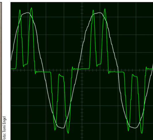
Bild 1 und Grafik 1: Der aus dem Babelbee-Projekt heraus entstandene Stromnetzanalyse-Computer „PowerBee“ mit Embedded-Linux kann ähnlich einem Oszilloskop die Verläufe der Netzspannung (Volt, weiss) und des Stromflusses (Ampere, grün) mit hoher Auflösung (24 Bit) aufzeichnen. Die Grafik zeigt 40 Millisekunden während eines Ladevorgangs mit einem aktuellen Batterieladegerät des Herstellers „Zivan“. Typisch für heutige Leistungselektronik ist, dass der Stromfluss (grün) keine Sinus-Welle mehr beschreibt.
