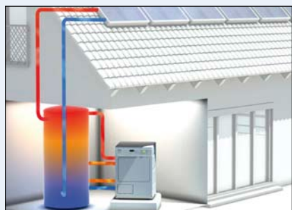
Bild 3: Solar Trockner mit Schichtenspeicher und Solarthermie
