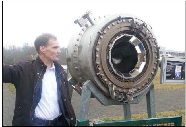
Bild 2: Volumetrischer Receiver zur solaren Methanreformierung (Wasserstoffherzeugung) (SCR)
