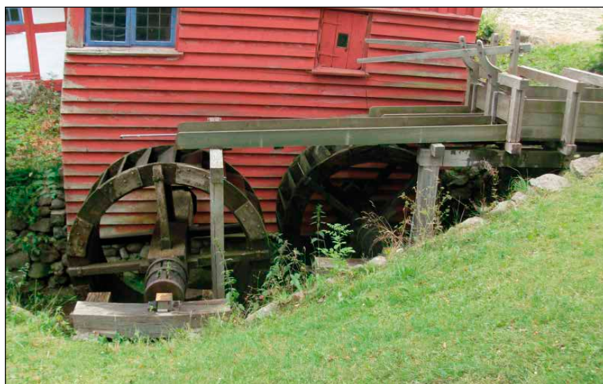
Bild 2: Zwei überschlächlige Wasserräder, Mühle Kaleko/Fünen
