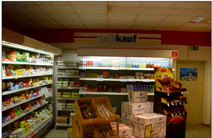
Bild 3: Optimierungsbedarf Beleuchtung: dunkle Ladenecken
