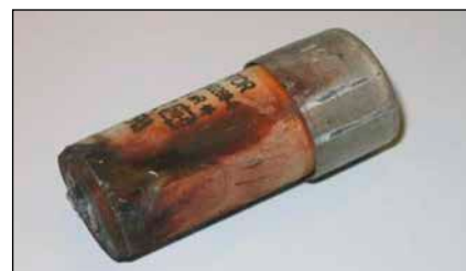
Bild 5: Ursache Lichtbogen in Sicherung
