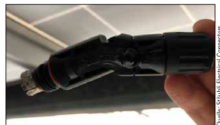
Bild 5: Verformte Steckverbindung (Kreuzverbund)
