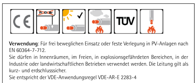
Bild 9: Auszug aus dem Datenblatt 07/2015, bei ansonsten unverändertem Datenblatt fehlt die Freigabe „für direkte Erdverlegung geeignet“.
