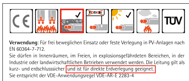
Bild 8: Auszug aus dem Datenblatt 09/2013, mit Freigabe „für direkte Erdverlegung geeignet“.
