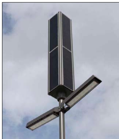
Bild 4: Towersun 128 EPS soltec. Kubischer PV-Aufbau mit Leuchten-Doppelausleger; Sonnenertrag von vier Seiten.
