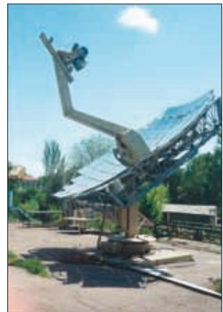
Bild 4: 1 kW-DISH-Sterling-Anlage, Durchmesser des Solar-Konzentrator = 5 m
