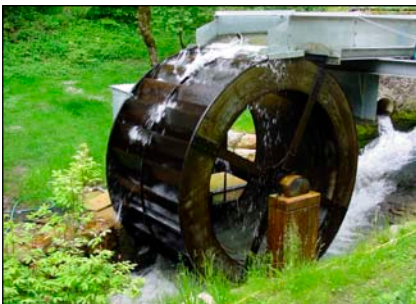
Bild 2: Ein modernes Wasserrad aus Metallkammern mit 14 kW im schweizerischen Cormoret.
