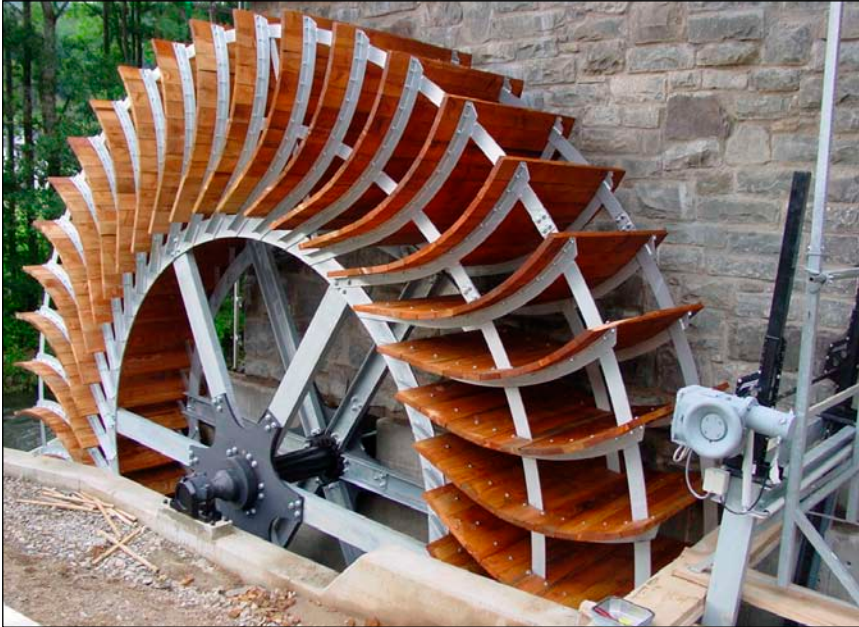
Bild 1: Zu sehen ist ein klassisches mittelschlächtiges Wasserrad mit 17 kW Leistung in Lennestadt im Sauerland.
