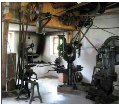
Bild 2: Transmissionen übertragen die Energie des Wassers auf die Maschinen
