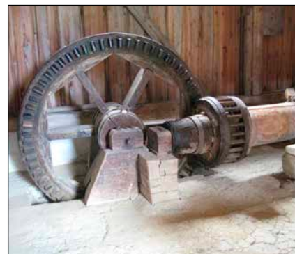
Bild 3: Getriebe zum Antrieb eines Hammerwerks
