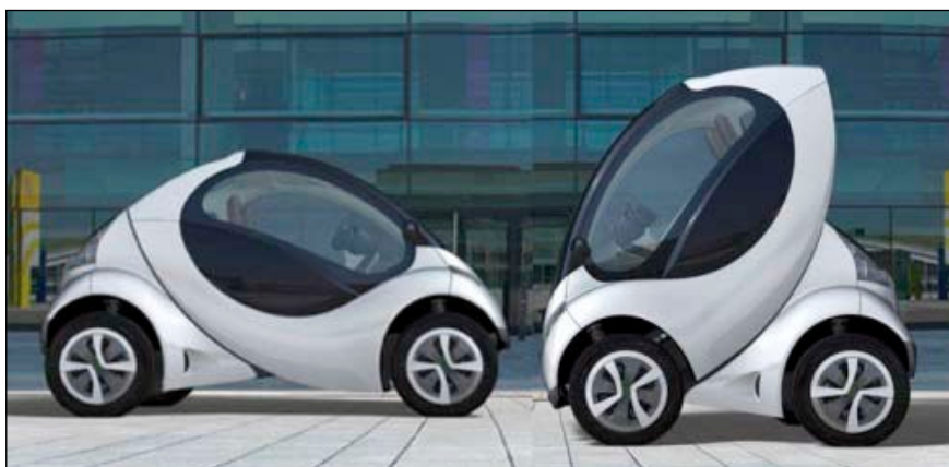
Bild 4: Ein langer Radstand ist für die normale Fahrt vorteilhaft. Doch zur Erleichterung des Ein- und Aussteigens als auch zur Reduktion der notwendigen Stellfläche kann das Fahrgestell des Hiriko Fold geknickt werden. Trotz der kompakten Bauform bietet das Stadtmobil zwei Sitzplätze und einen kleinen Kofferraum.
