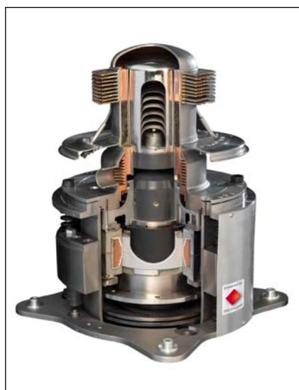
Bild 4: Durch „Freikolbentechnik“ ist der Microgen-Stirlingmotor nahezu verschleißfrei und dadurch wartungsarm. Der Arbeitskolben ist hier direkt mit dem Erreger des Lineargenerators verbunden. Ein Kurbeltrieb ist nicht erforderlich. Die bereits erhältlichen Strom erzeugenden Heizungen von DeDietrich-Remeha, Senertec und Viessmann setzen auf den Microgen-Stirling.
