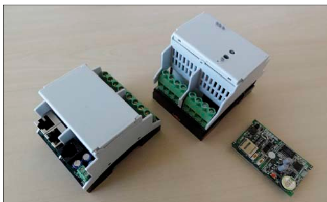
Bild 2: Der aus dem Babelbee-Projekt heraus entstandene Stromnetzanalyse-Computer mit Embedded-Linux kann die Netzfrequenz (und 100 weitere Netzkennzahlen) mit hoher Auflösung erfassen und diese Messwerte dokumentieren.
