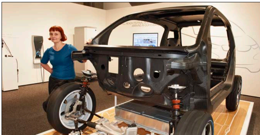
Bild 2: Die Karosserie des ersten Serien-Elektroautos von BMW ist komplett aus Kohlenstofffaserverstärktem Kunststoff (CFK) gefertigt. Von dieser Konstruktion ist auch Hanne Dinkel überzeugt, die für die Energieversorgung im Leipziger BMW-Werk verantwortlich ist
