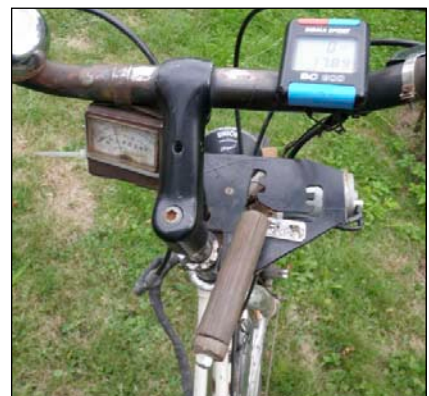
Bild 4: Schaltung durch Schaltkulisie 1. Gang, 2. Gang, Leerlauf
