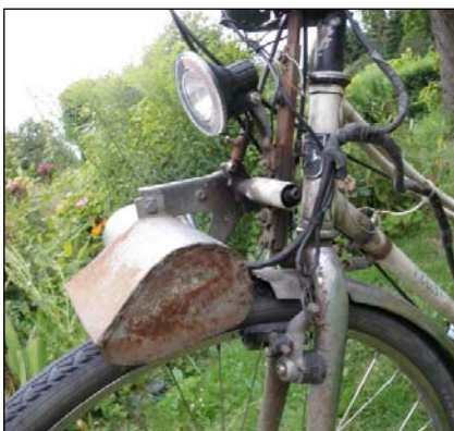
Bild 2 und 3: Gleichstrommotor mit verkleideter Reibrolle
