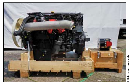
Bild 3: Der Elektroantrieb des e-Force-LKW im Vergleich zu einem konventionellen LKW-Dieselmotor
