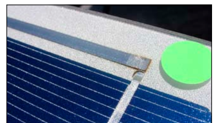
Bild 2: Heiße Lötverbindung in einem PV Modul
