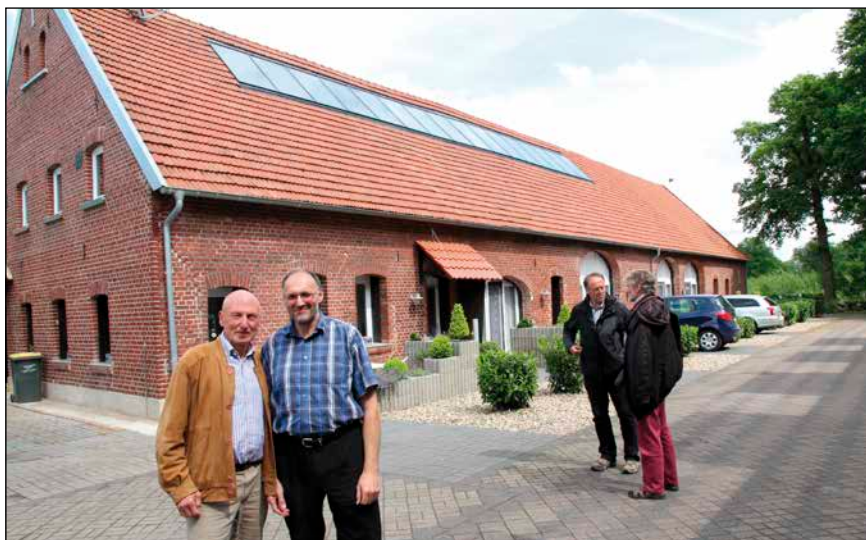
Bild 1: Hausherr Rudolf Schnieder (rechts) und DGS-Vorsitzender Dr. Peter Deininger. Im Hintergrund der ehemalige Sauenstall mit der ins Dach eingebauten Solarthermieanlage (40 m²). Sie leistet im Sommer bis zu 40 kW.
