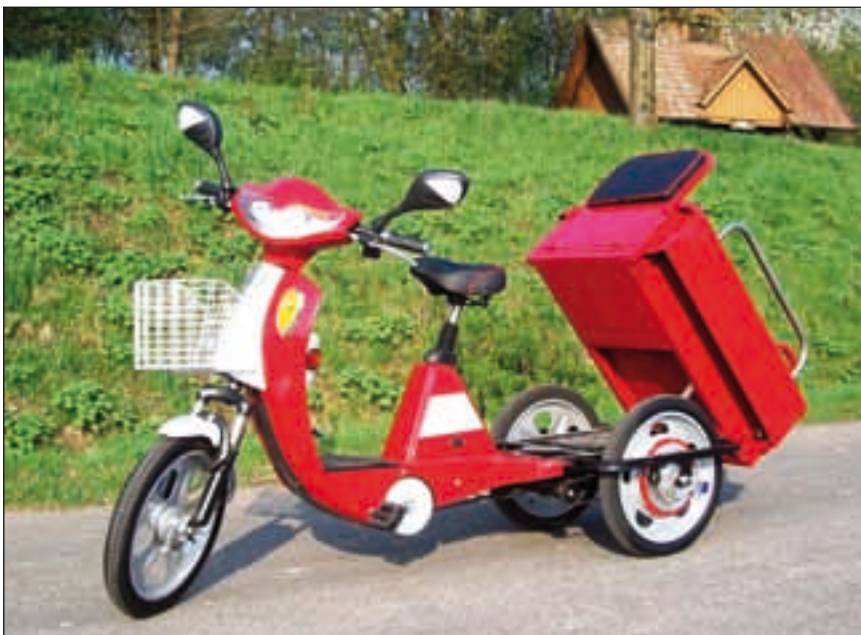
Die kleine Version des E-Trike: das Quickly. Auch dieses Fahrzeug hat eine kippbare Lade­fläche, die auch mit Sitzen ausgestattet sein kann. Rechts: oben der Antrieb; unten die Anzeige.
