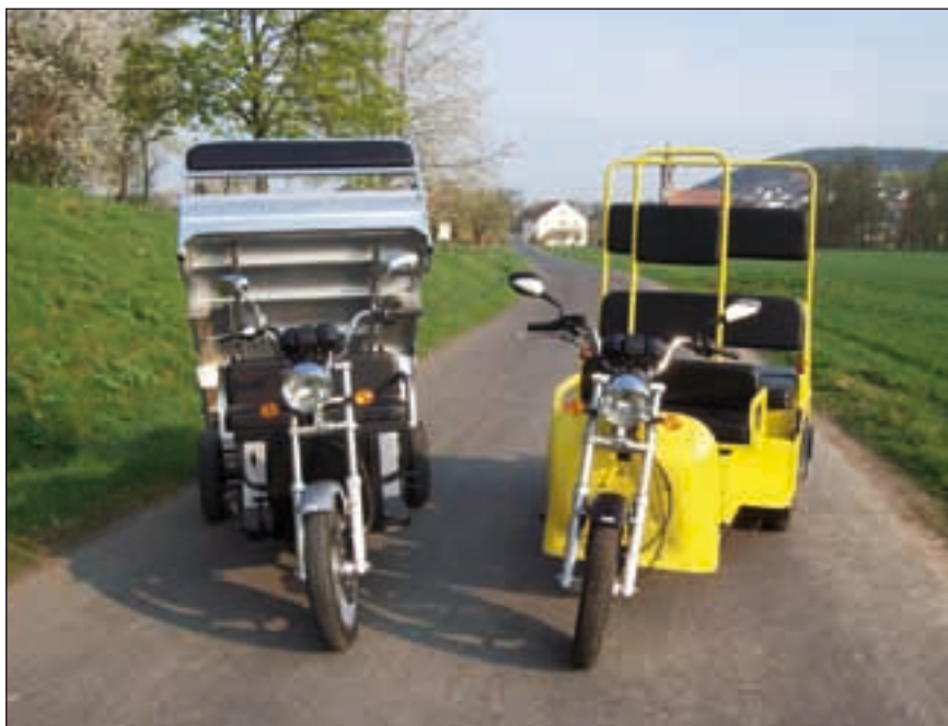
Links Cargo mit der klappbaren Ladefläche; rechts die E-Trike-Taxiversion mit fünf festen Sitzen
