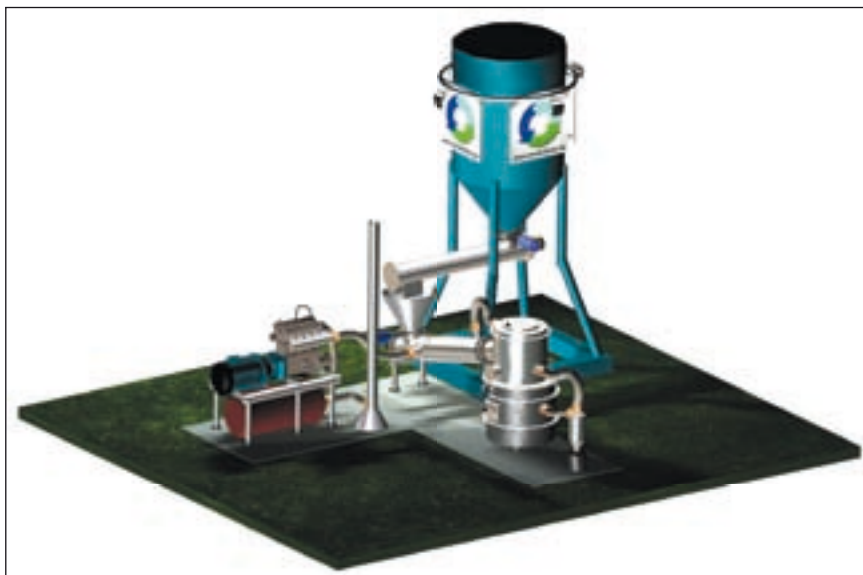
3D-Modell einer Joos-Vergasungsanlage für Holzhackschnittzel
