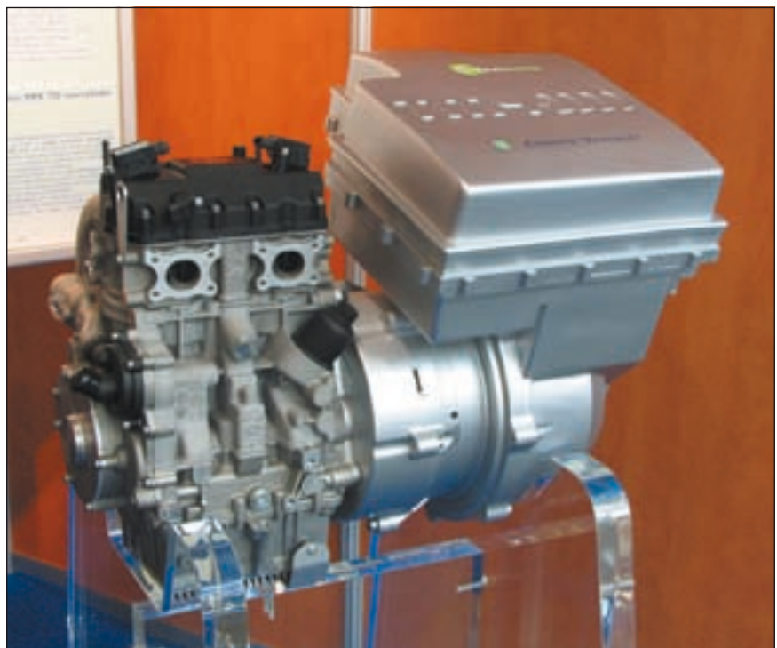
Die neueste Cleanova-Antriebseinheit wurde vor wenigen Monaten auf der EVER in Monaco vorgestellt. Die Leistung des Elektroantriebs erhöht sich auf 60 kW.
