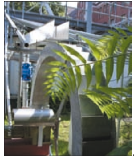
Bild 2: Das ABC der Kleinwasserkraftnutzung – ein überschlängiges Wasserrad
