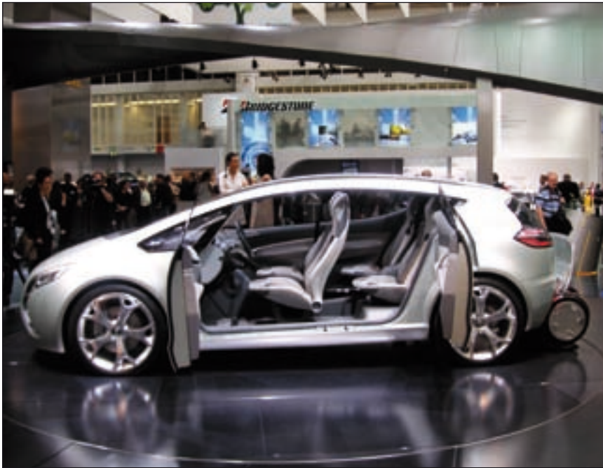
Der Opel Flextreme basiert auf dem E-Flex Antriebskonzept des Mutterkonzerns GM. Die Batterien sitzen in der Mittelkonsole.
