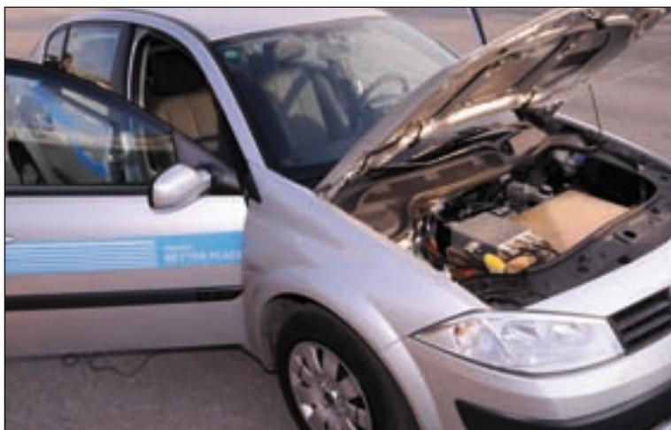
Das erste Testfahrzeug von Project Better Place ist ein Renault Megane. Die Antriebstechnik mit NetZRückspeisung stammt derzeit offenbar noch vom kalifornischen Elektroautoumrüster AC-Propulsion.
