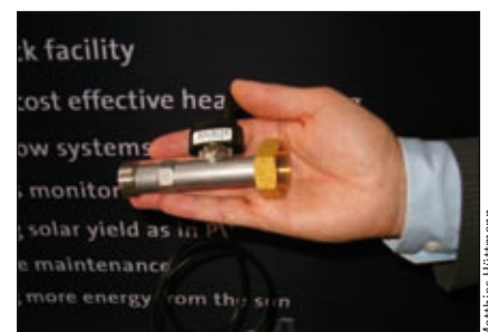
Bild 3: vorgestellt: Volumenstrommessung ohne bewegliche Teile (Fa. Grundfos)
