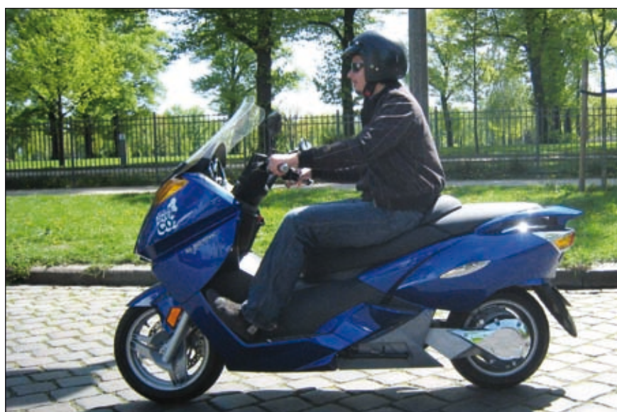
Der Vectrix Maxi-Scooter bietet Platz für zwei Personen und fährt sich wie ein echtes Motorrad. Dank Elektroantrieb ist es jedoch frei von Abgasen, Lärm und Motorradsteuer.
