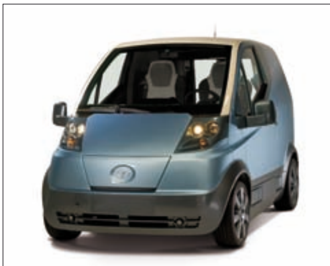
Bild 2: Von vorne sieht der Quicc DiVa wie ein normaler PKW aus. Die Karosserie besteht vollständig aus wiederverwertbarem Kunststoff. Bei Serienfertigung soll dies auch für das Fahrwerk gelten.
