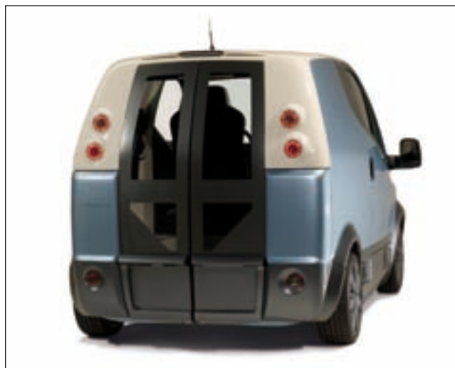
Bild 3: Das Heck ist geprägt von der zweiteiligen Innenschwentrückwand, durch die man auch in sehr beengten Parksituationen gut in den Laderaum gelangen kann.
