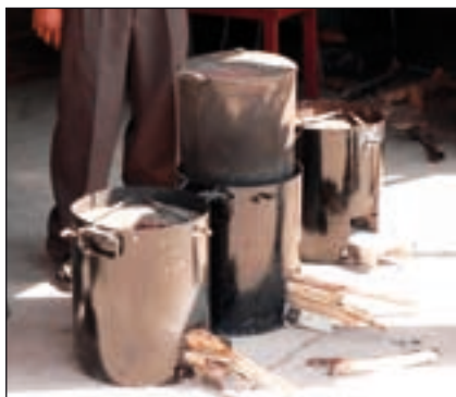
Bild 2: Rocket Stoves – effizient Kochen mit feinen Holzscheiten
