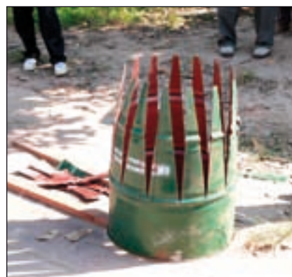
Bild 5 und 6: Bau des trichterförmigen Brennstoffsilos
