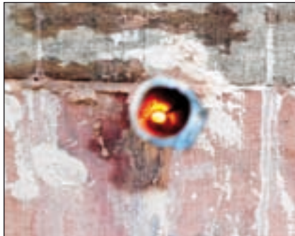
Bild 9: Kohlevorrat und Glutbett des Vergasers
