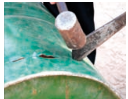
Bild 11: Die traditionelle Weise, ein Fass aufzumachen – schnell, leise, präzise, ohne Funkenflug und scharfe Grate
