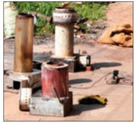
Bild 3: „High-end“ Versionen des Rocket Stoves – Kochen mit Reisspelzen und externem 12 V Lüfter
