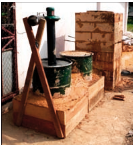
Bild 8: Links: Holzgaserzeuger mit Gaskühler und aufgesetztem Gebläse. Rechts: Dr.-Ing Jan Kai Dobelmann, DGS und Dr.-Ing. Jens Berkan, Innowatt Energy
