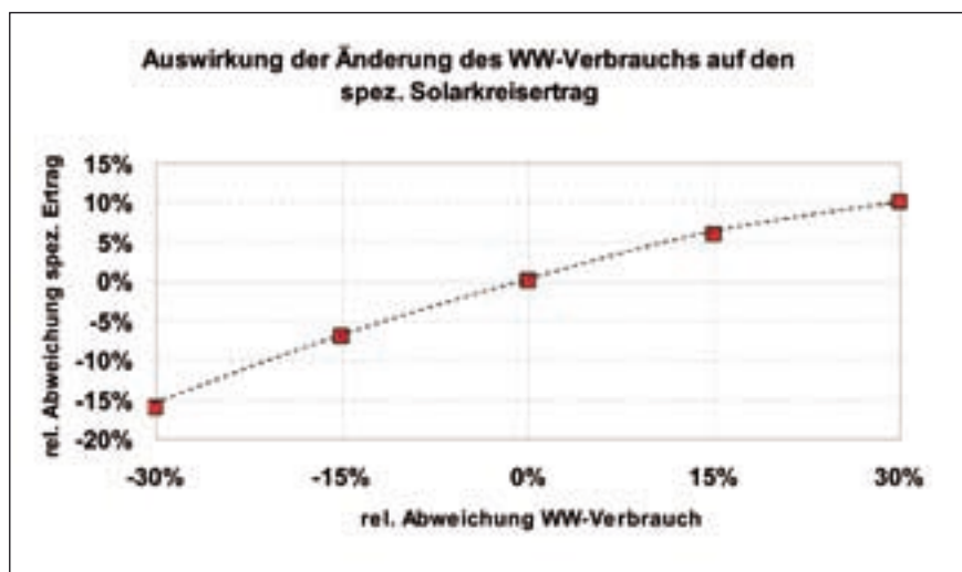
Bild 2: Der spezifische Solarkreisenertrag in Abhängigkeit vom WarmwasserVerbrauch
