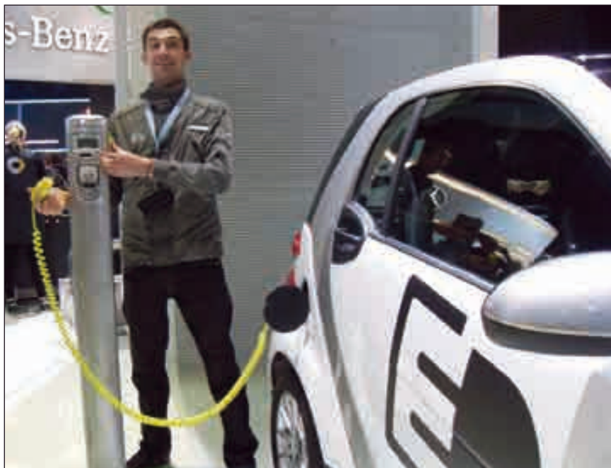
Bild 7: Aufgrund der geringen Kosten und der großen Flexibilität wird die Kombination aus Stromstelle (der Ladesäule) und Ladekabel mit Steckkontakt bis auf weiteres die dominierende Infrastruktur für individuelle Elektroautos bleiben. Automatische Systeme scheitern am Preis und der Tatsache, dass auch im ordentlichen Deutschland auf den Parkplätzen keine mathematisch exakte Ordnung, sondern eher geregeltes Chaos herrscht.
