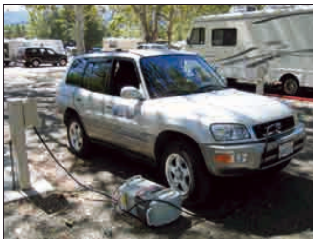
Bild 4: Ein mobiles Induktionsladesystem lädt einen Toyota RAV4-EV auf einem Campingplatz mit Strom aus der Steckdose.
