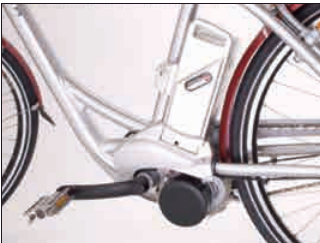
Bild 5: Der Wechselakku eines Pedelecs ist klein, handlich und lässt sich einfach tauschen bzw. zur Ladestation tragen.
