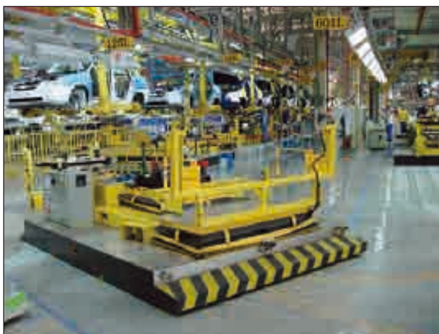
Bild 3: Autonome Industriefahrzeuge werden durch Induktionsschleifen gelenkt und gleichzeitig mit Energie versorgt.
