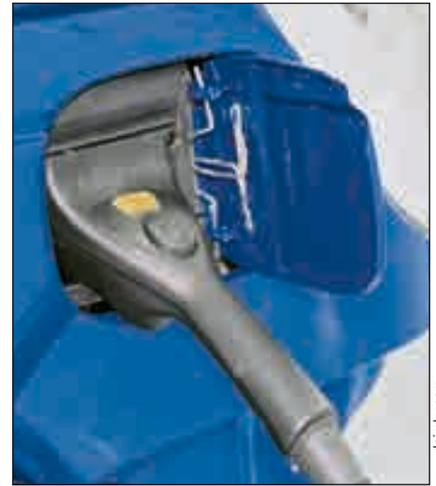
Bild 2: Die Ladeklappe des Sprinter PHEV
