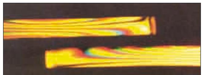
Bild 2: elastische Verklebung – Lasteinleitung über die Vollfläche
