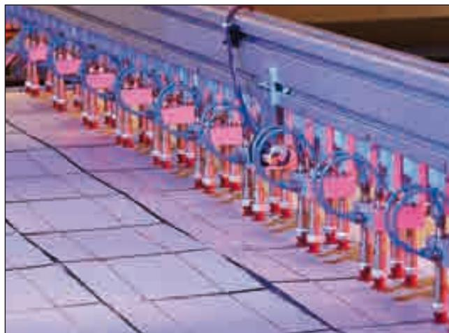
Zellenstrings werden automatisch vor der Laminierung abgesetzt.
