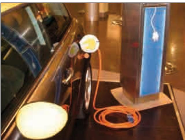
Bild 3: Der BMW Mini E bedarf eines extrem langen Ladekabels, weil die Ladebuchse unter dem Tankdeckel hinten links sitzt.
