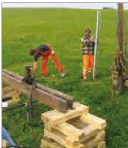
Bild 5: Projektspezifische Probelastung eines Kleinpahlelementes
