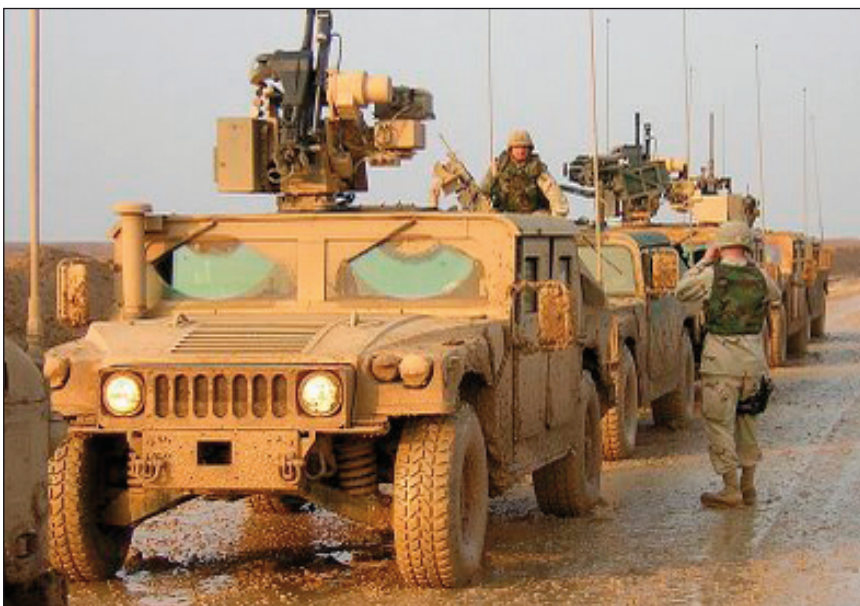
US-Militärfahrzeug HMMWV mit 190 PS Dieselaggregat, 95 Liter-Treibstofftank und 8,7 kW Klimaanlage verbraucht bis zu 70 Liter/100 km im harten Militäreinsatz
